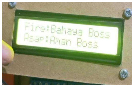
Gambar 10 Tampilan LCD & Notifikasi Telegram Pada Sensor Flame
