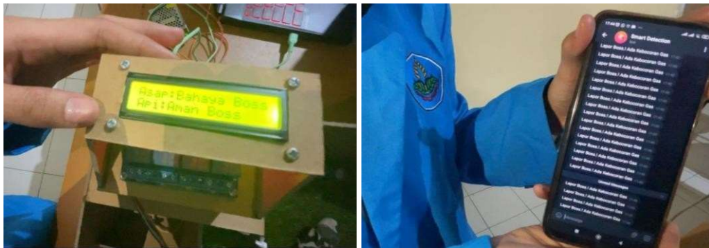
Gambar 8 Tampilan LCD & Notifikasi Telegram Pada Sensor MQ-2
