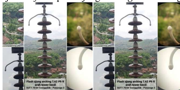
Gambar 8. Flash pada ujung arching T.62 saat gangguan [10]
