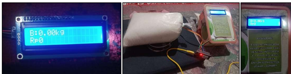
Gambar 6 Hasil Pengujian Tombol Tare
